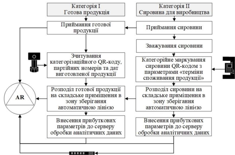
Рисунок 1. Автоматизована система приймання сировини та готової продукції постачальника
